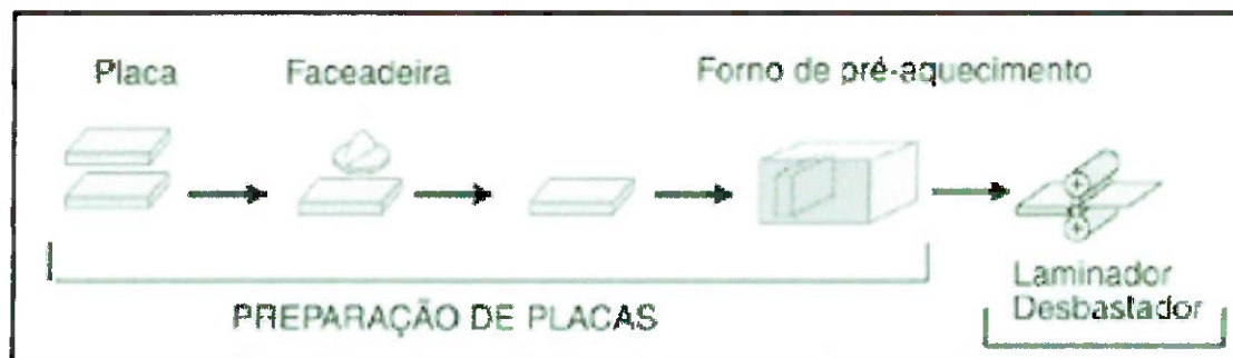
FIGURA 2.6 - PROCESSO DE LAMINAÇÃO A QUENTE. ( http://www.abal.org.br , 2008)
